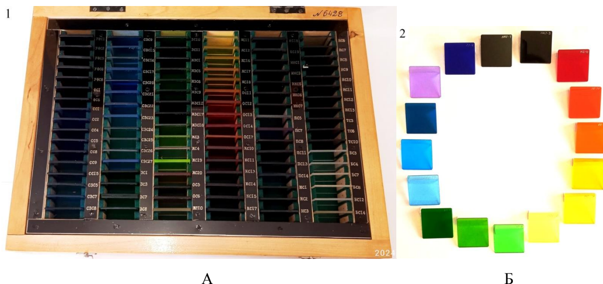
Рис 1 – Набор образцов стандартных цветных оптических стёкол включающий: 1(А) – типы стёкол, каждый из типов стекла подразделяется на марки оптического стекла обозначаемые аббревиатурой с номером (см. обозначения ячеек); 1(Б) – представлены по спектральному кругу в форме квадратной таблички примеры цветных оптических стекол следующих марок: ИКС-3 (инфракрасное стекло-3), КС-11 (красное стекло-11), ОС-14 (оранжевое стекло-14), ОС-12 (оранжевое стекло-12), ЖС-18 (жёлтое стекло-18), ЖС-16 (жёлтое стекло-16), ЖС-19 (жёлтое стекло-19), ЗС-8 (зелёное стекло-8), ЖЗС-1 (жёлто-зелёное стекло-1), ЗС-11 (зелёное стекло-11), СЗС-17 (сине-зелёное секло-17), СЗС-7 (сине-зелёное стекло-7), СЗС-9 (сине-зелёное стекло-9), ПС-7 (пурпурное стекло-7), СС-4 (синие стекло-4), УФС-1 (ультрафиолетовое стекло-1).
