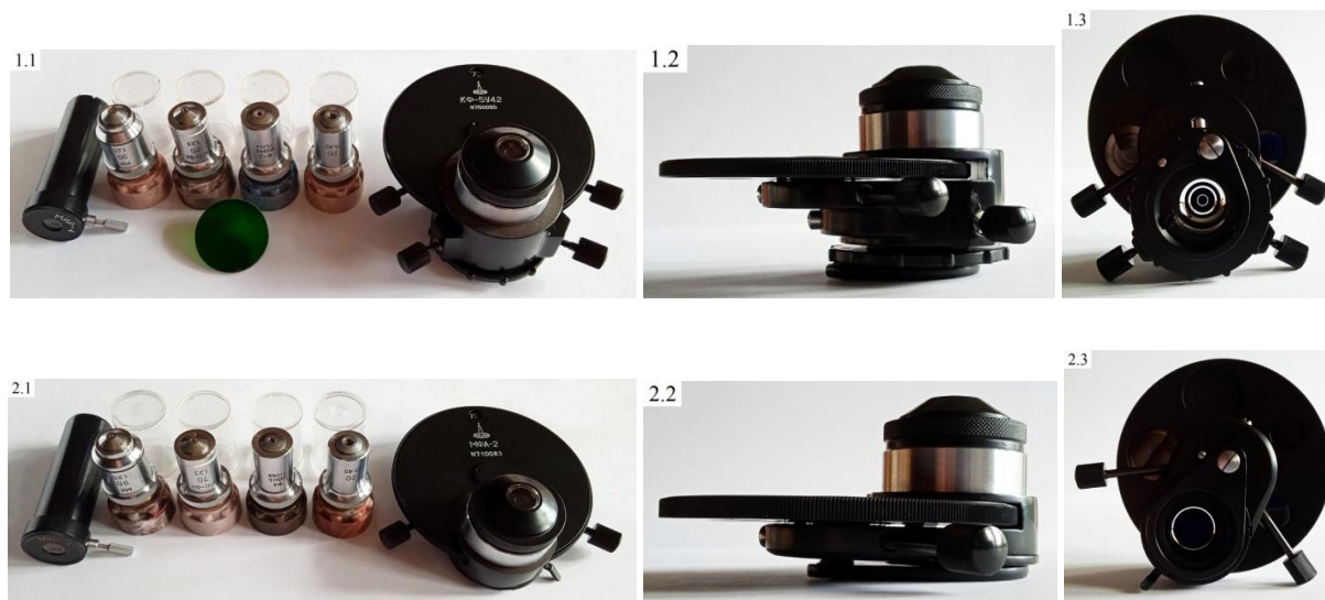
Рис. 1.: 1.1 Общий вид комплекта фазово-контрастного устройства КФ-5 ЛОМО: представлены с лева на право – микроскоп вспомогательный МИР-4, светофильтр ЗС-2, фазовые объективы, конденсор КФ-5; 1.2 конденсор КФ-5 вид с боку; 1.3 конденсор КФ-5 вид со стороны люка апертурной диафрагмы; 2.1 Общий вид комплекта фазовотемнопольного устройства МФА-2 ЛОМО: представлены с лева на право – микроскоп вспомогательный МИР-4, фазовотемнопольные объективы, конденсор МФА-2; 2.2 конденсор МФА-2 вид с боку; 2.3 конденсор МФА-2 вид со стороны люка апертурной диафрагмы.
