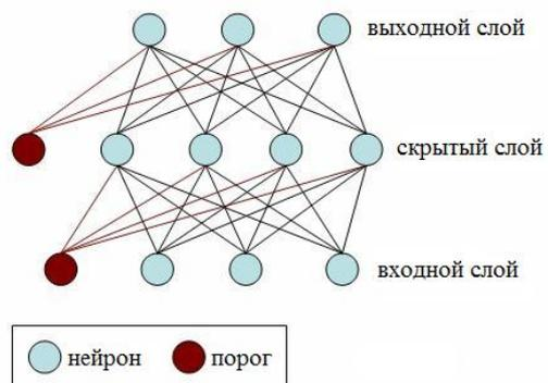
Рисунок 4 – Схематическое изображение полносвязной двухслойной нейронной сети МП2, в которой имеется три входные переменные, четыре скрытых элемента (нейрона) и три выходные переменные. Скрытый и выходной слои содержат дополнительный элемент – порог. Пороговый элемент – это нейрон,
