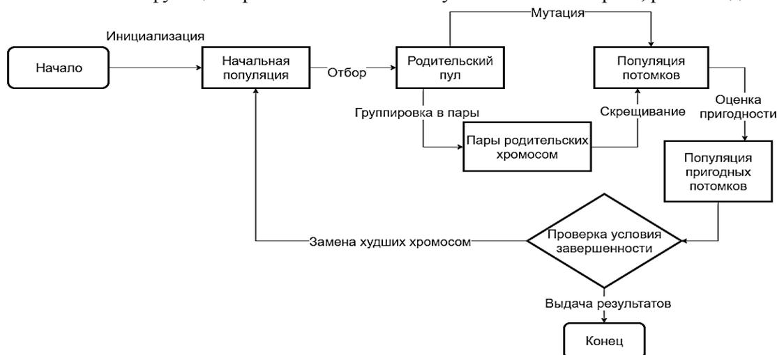
Рис.1 –Блок-схема работы генетического алгоритма
